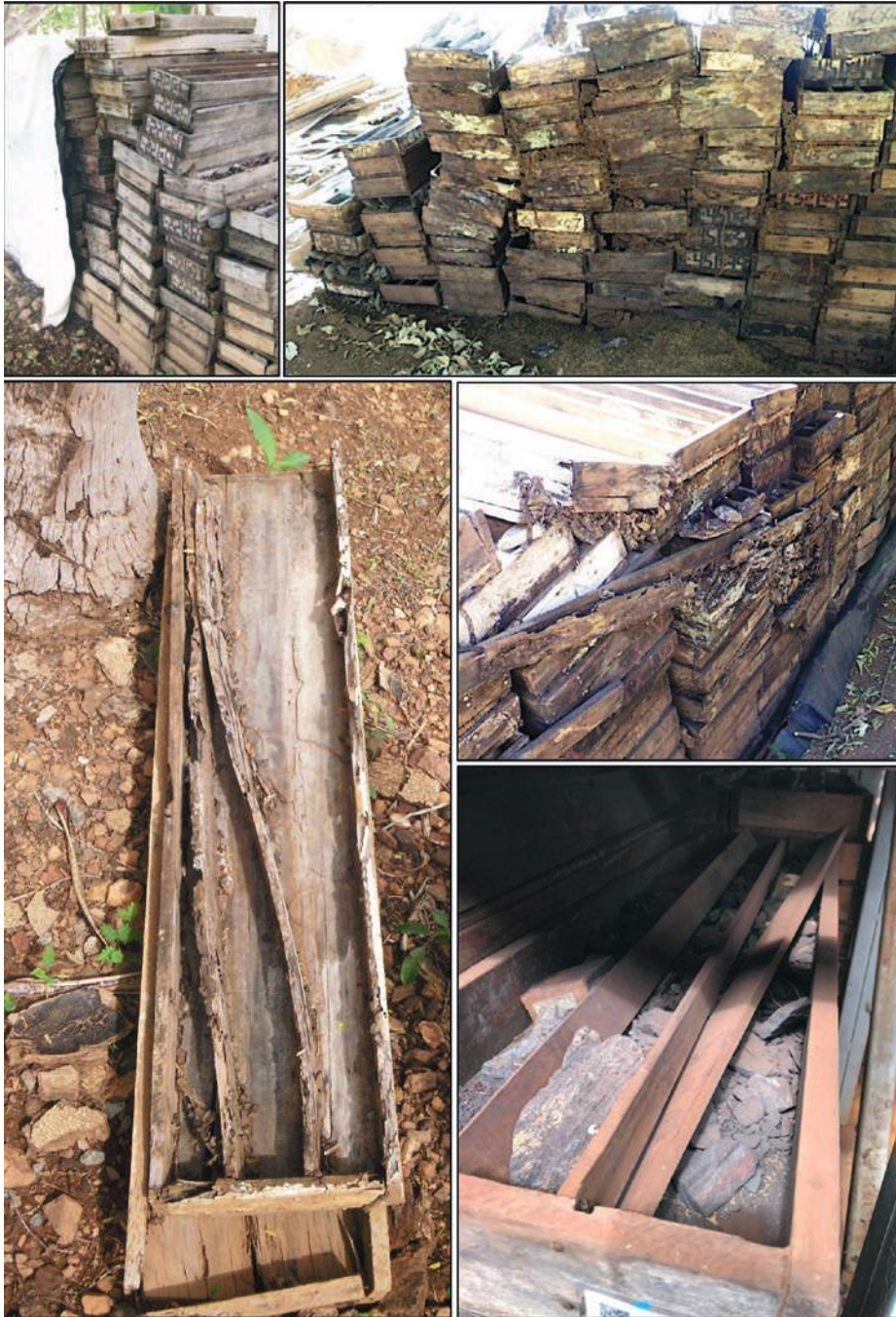
Figura 5 – Exemplo de armazenamento de amostras de testemunhos de sondagem totalmente inadequado.
