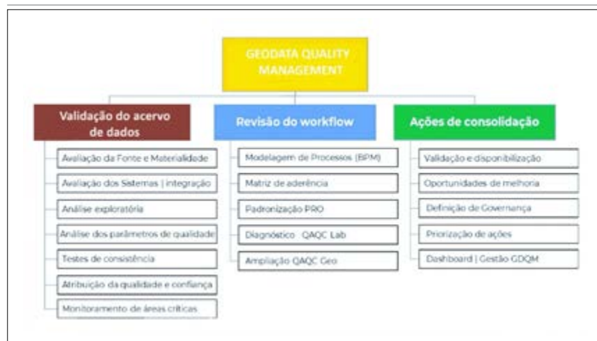
Figura 1 – GDQM: metodologia de avaliação da qualidade de dados geológicos, definida por Cuchierato (2022)
