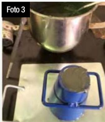
por meio de testes de umidade, granulometria a laser e densidade. Na sequência, foram reproduzidos em laboratório 48 corpos de prova cilíndricos, de 5 x 10 cm, divididos em quatro traços diferentes, com variação da porcentagem de cimento Portland aplicada de 1%, 2,5%, 3,5% e 5% moldados em corpos de prova cilíndricos de 5 x 10 cm (Foto 1). Realizaram-se, então, ensaios de mini abatimento (mini slump-test) e de resistência à compressão uniaxial, de acordo com o tempo de cura 7, 14, 21 e 28 dias.
